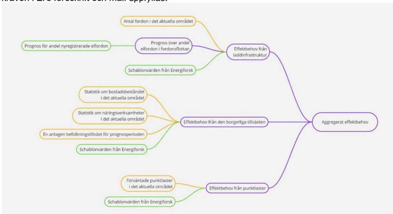
Figur 2 - Schema över hur prognosverktyget är uppbyggt. Gröna boxar är sådana som tillhandahållits av Energiforsk, orangea boxar är sådana användaren behöver fylla i själv och lila boxar är resultat som bygger verktygets beräkningar.
